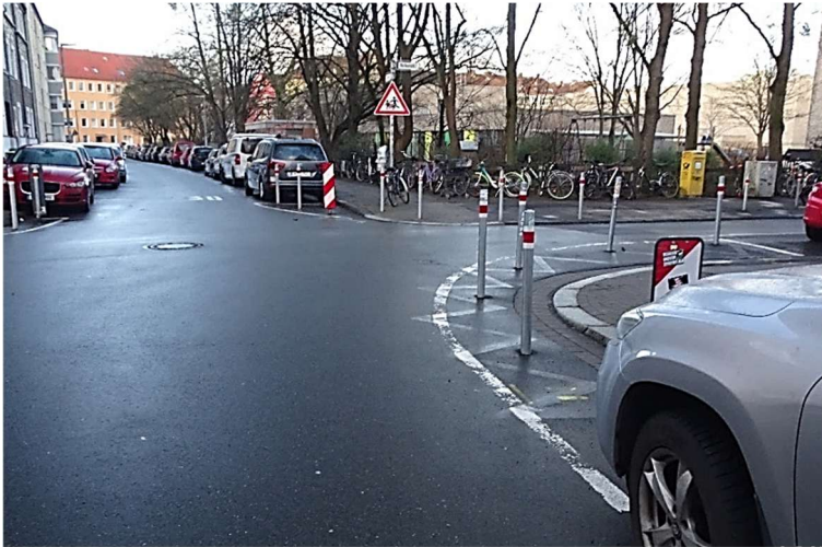
Abbildung 20: Freihalten der Eckbereiche eines Rechts-vor-Links-Knotenpunktes durch Pfosten.
